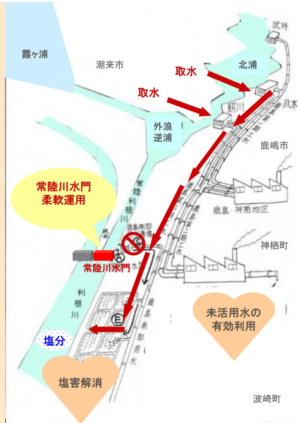
◆柔軟運用のフロー図 塩害の生じない範囲で水門を開放し 魚類の遡上を促す。塩水くさびと共に魚が湖に遡上する。
